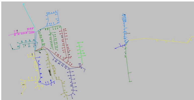
Figuur 7: Het grootste en het kleinste netwerk in termen van aansluitingen dat is meegenomen in de studie. Elke kleur representeert een andere streng vanaf de transformator.
