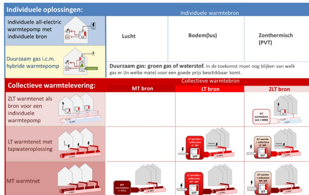
Figuur 6. Overzicht technische oplossingen voor verwarmen.
